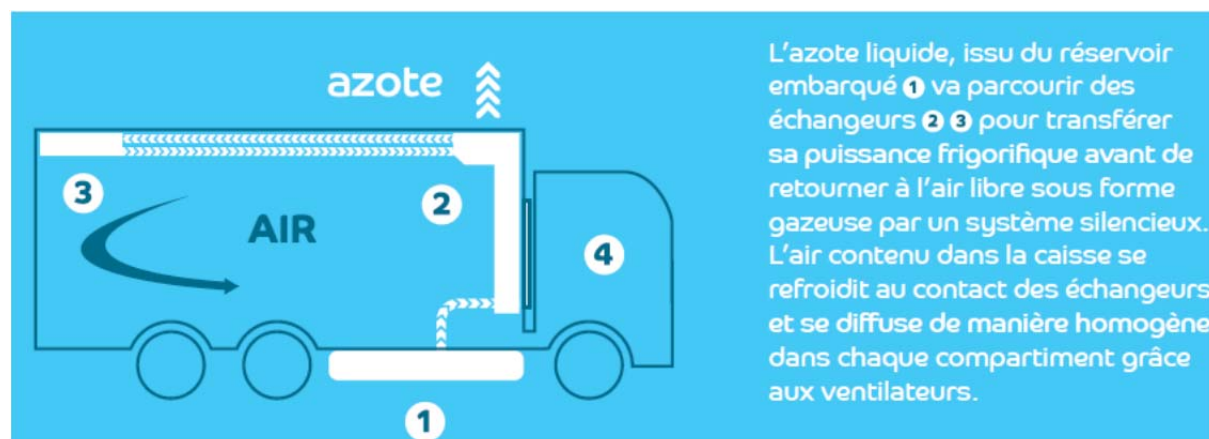
Figure 6.28 Schéma de principe d'un système frigorifique dit « indirect » (source Air Liquide)
